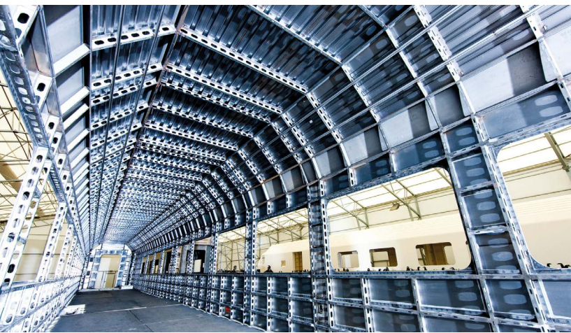
Waggonbau: Recyclinggerechtes Design von Bauteilen ermöglicht eine hohe Wiederverwertung.
