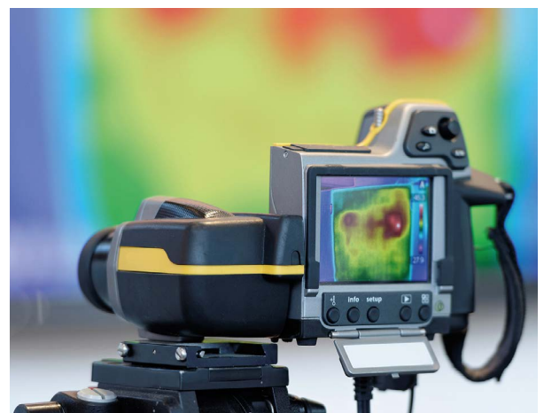
Thermografie zur zerstörungsfreien Werkstoffprüfung
