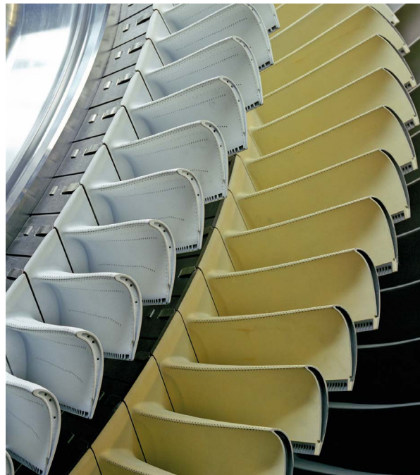
Innengekühlte Turbinenschaufeln mit Wärmedämmschichten für höchste thermische Beanspruchungen
